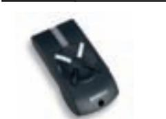
2/4 Kanal Handsender, Modell Atmosfera, 433 MHz Rolling Code. Mittels Sequenzcodierung ist ein einmehrfach Einlernen möglich. Das ADVANTAGE System erleichtert und beschleunigt das Einlernen. Min. Verp. 10 St.
