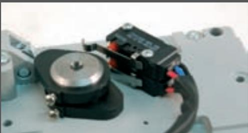
Mit integrierten und vorverkabelte Endschaltern
