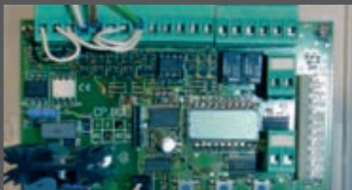
CP.BULL steuerung mit integriertem Display und einfache Verkabelung
