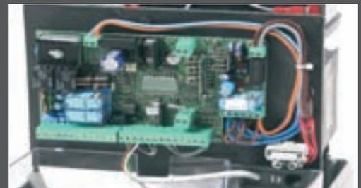
Die 24 Vdc Ausführung bietet eine integrierte Batterieladekarte für Stromausfälle. Batterie separat mitbestellen
