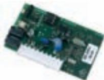
2-Kanal -Empfänger mit Molexsteckverbindung.
