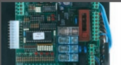
Steckbare Anschlußterminals, machen die Installation schneller und einfacher
