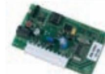
1/2-Kanal -Empfänger mit Molexsteckverbindung. Nur für Handsender Rolling Code.
