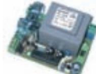
Netzteil zur Versorgung von Elektroschlössern und Beleuchtungen, für 230V Steuerungen. Max 1000 W. Verstellbare Geschwindigkeit mittels Trimmer
