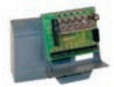
Master/Slave Karte für Schiebetore, ermöglicht die synchronisierte Bewegung von 2 Antrieben
